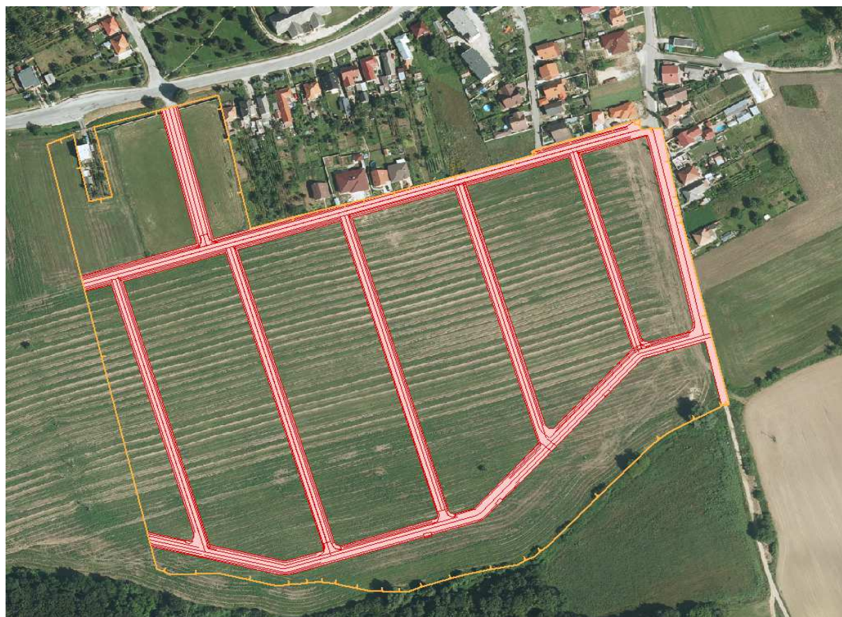
Obr. č. 8: Navrhovaná sieť miestnych obslužných komunikácií s napojením na existujúce komunikácie
